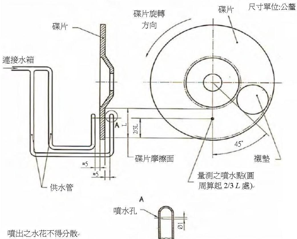
碟式煞車灑水裝置應以下述方式安裝：
