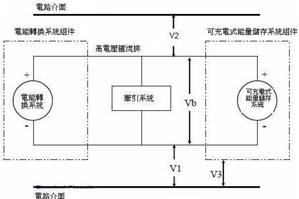
圖一： $V_b$ 、 $V_1$ 、 $V_2$ 之量測
