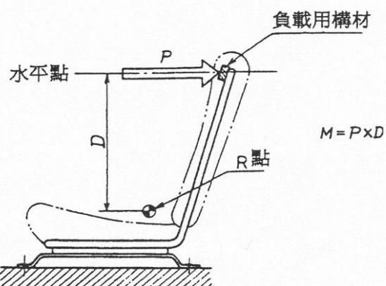
圖一 椅背強度試驗(示意圖)
