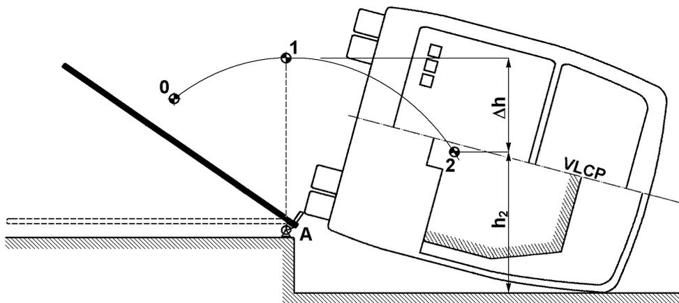
圖11 重心高度位移變化示意圖
