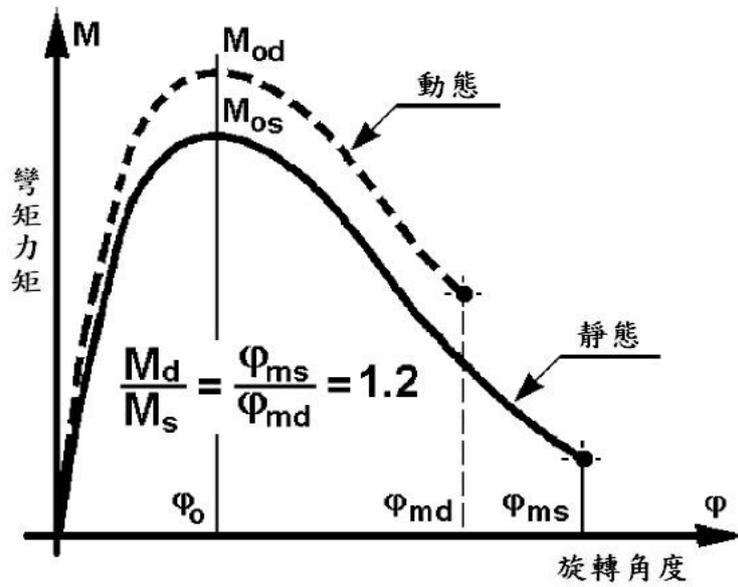
圖15 靜態與動態測試之彎矩-角度關係圖
