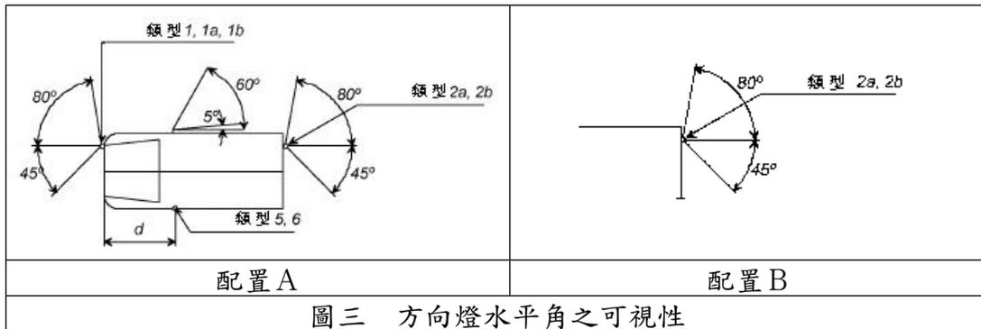
4.8.5.2 垂直角：類型1,1a,1b,2a,2b及5之方向燈應為水平面上上下各一五度；若裝置高度小於七五〇公釐，水平面下方之垂直角可減為五度。類型6之方向燈應為水平面上方三〇度，下方五度。額外裝置之方向燈，其距地高在車輛無負載狀態時大於二一〇〇公釐者，水平面上方之垂直角可減為五度。
