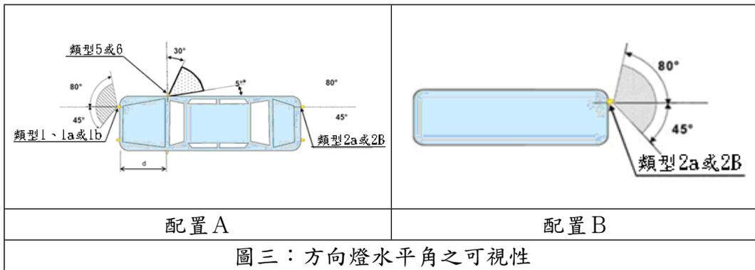
備註：M1與N1類車輛之1、1a或1b方向燈，水平朝內夾角為四五度，若車輛在無負載狀態時距地高小於七五〇公釐，則水平面下方之水平角可減為二〇度。
