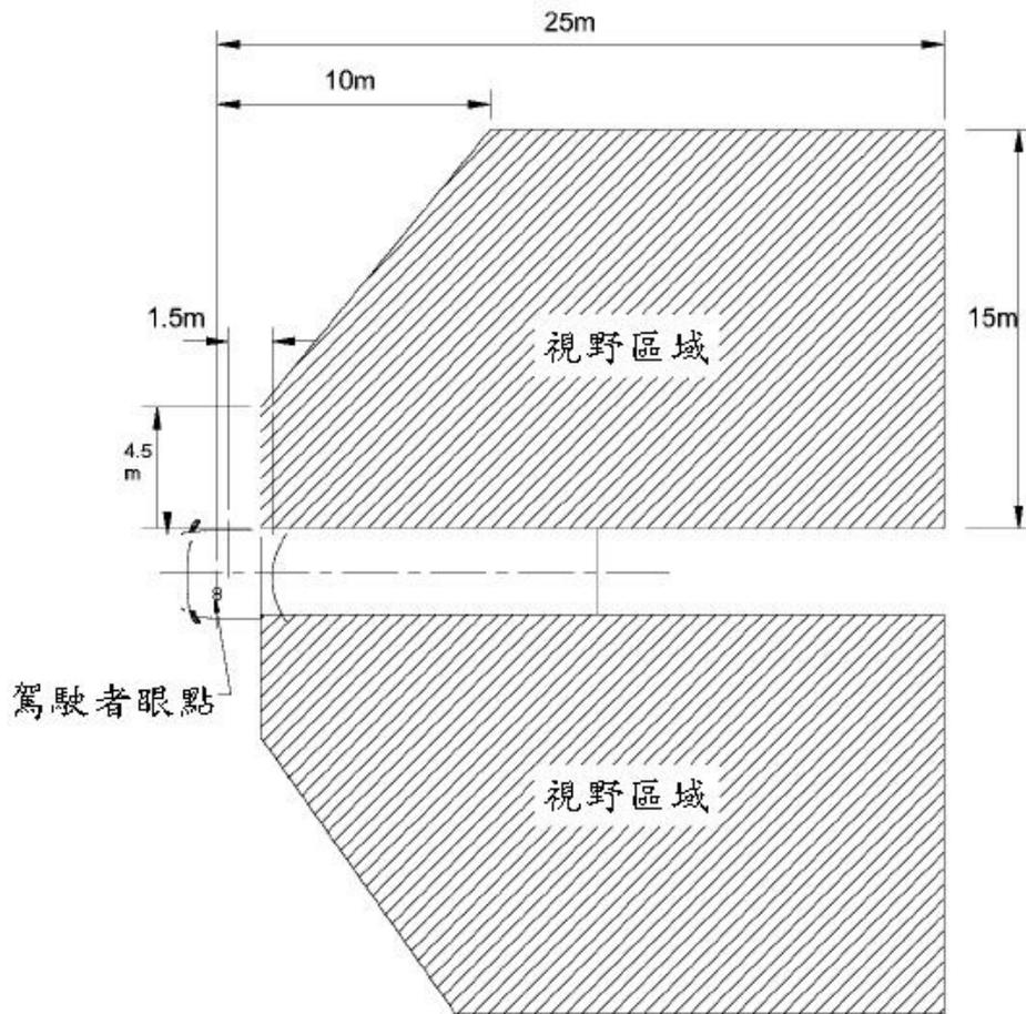
圖五 廣角車外視鏡 (IV類) 視野示意圖
