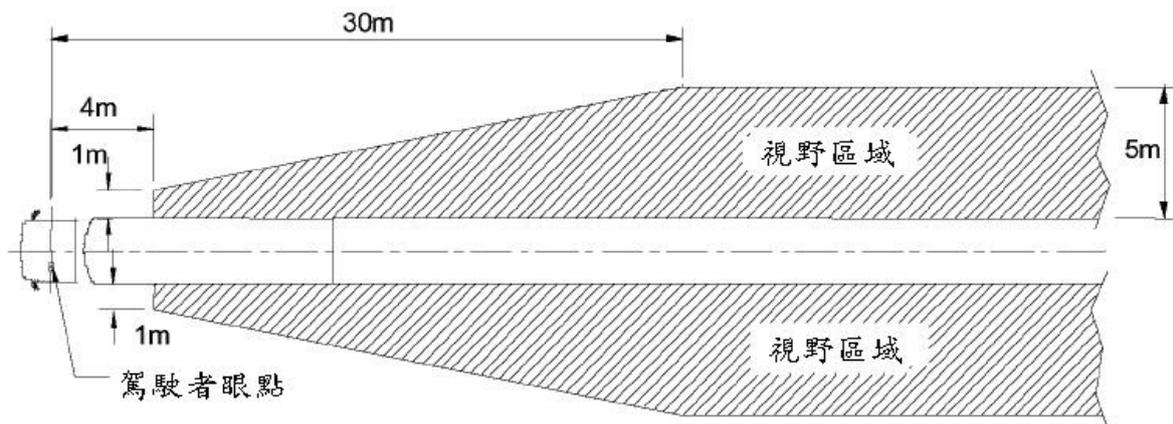
圖三 車外照後鏡(II類)視野區域
