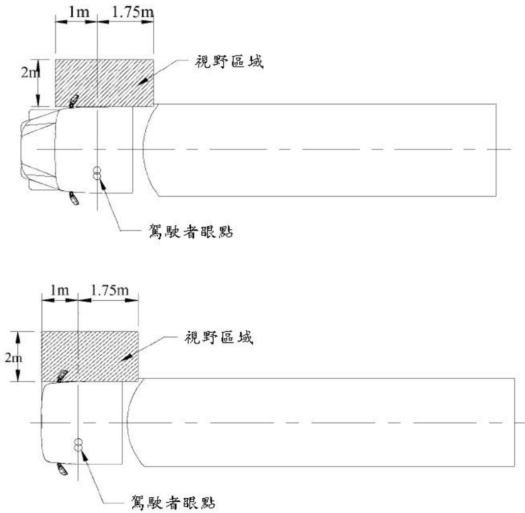
圖六 A、B近側車外視鏡（V類）視野區域
