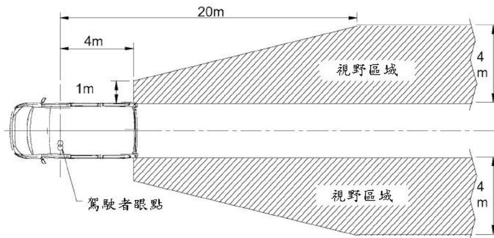
圖四 車外照後鏡 (III類) 視野區域
