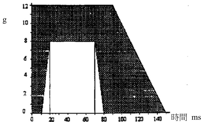
圖五：台車衝擊時之減速度或加速度
