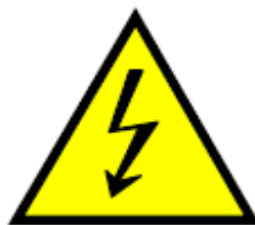
圖一：高電壓裝備之標識
