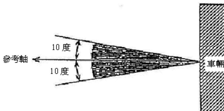
圖三 類型SM1與SM2之最小垂直照射角度
