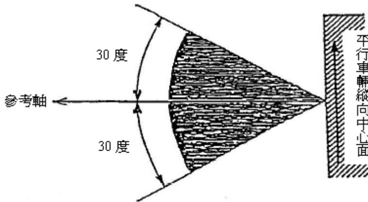
圖五 類型SM2最小水平照射角度
