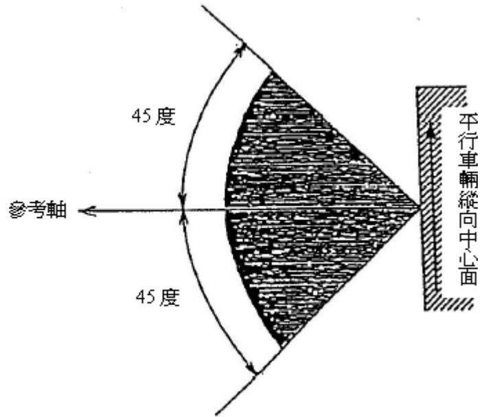
圖四 類型SM1最小水平照射角度
