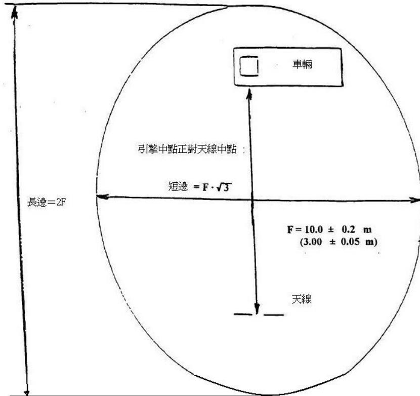
圖八：電磁反射示意圖
