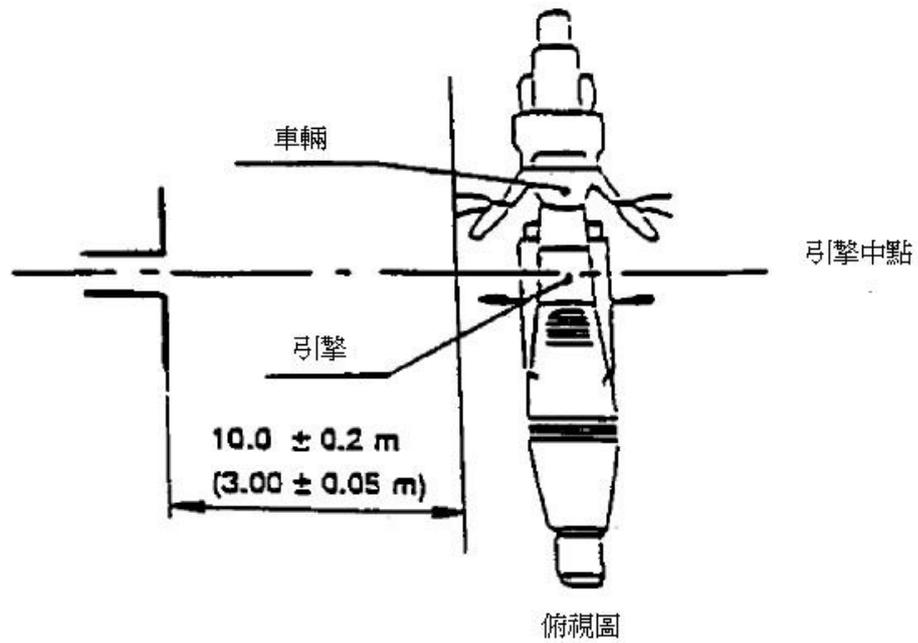
水平極化量測示意圖
