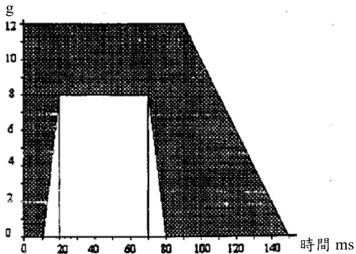
圖五：台車衝擊時之減速度或加速度
