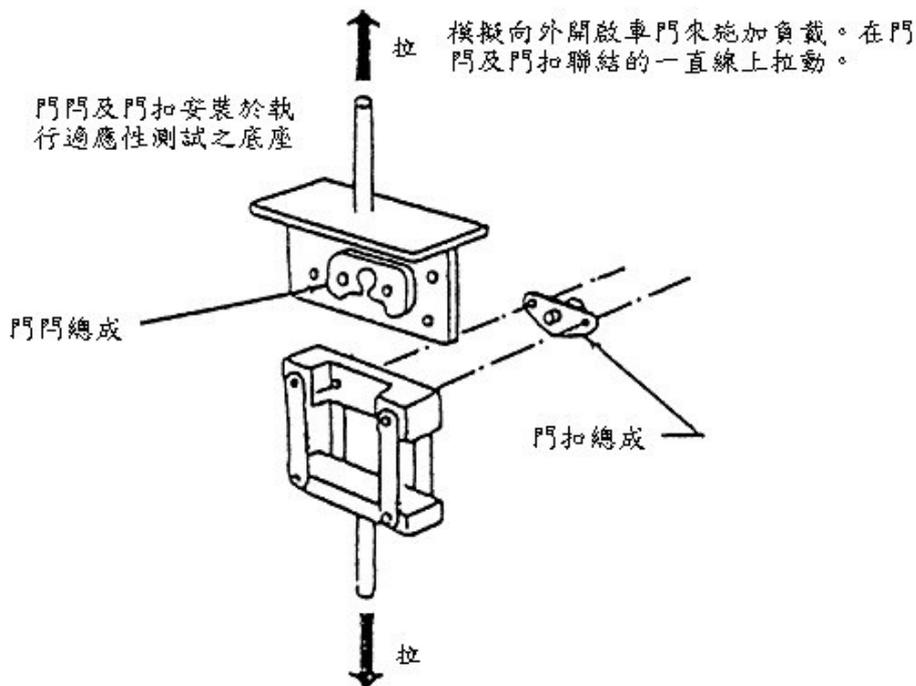
圖二 門門-負載測試二之抗拉測試
