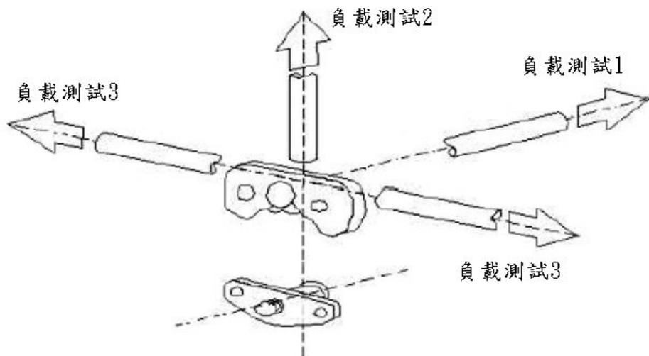
圖四 門門靜態負載試驗拉力方向
