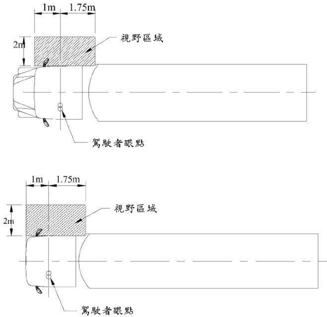
圖六 A、B 近側車外視鏡（V類）之地面視野區域
