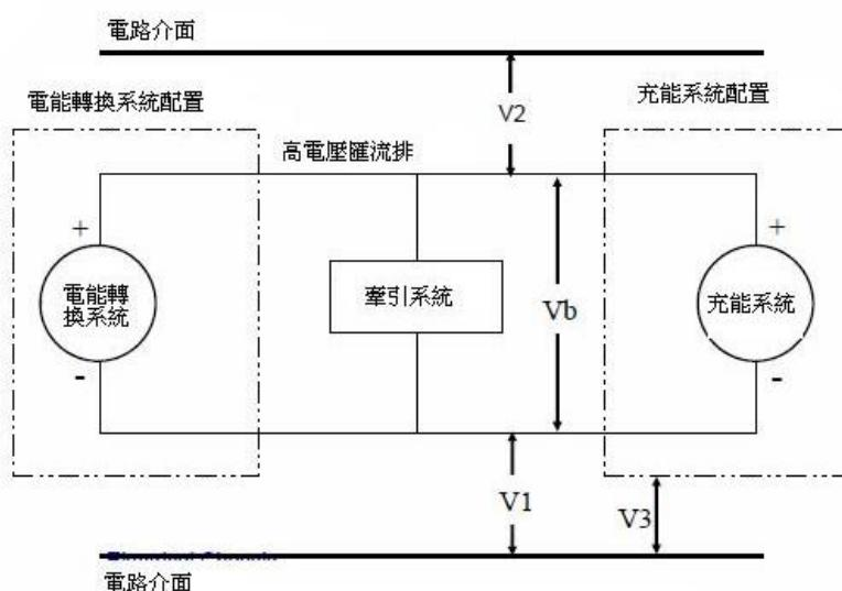
圖四： $V_b$ 、 $V_1$ 、 $V_2$  之量測
