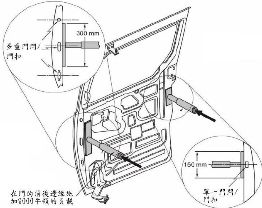
圖十 側滑動門完整車門系統試驗
