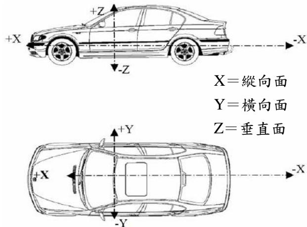
圖七 慣性負載測試之座標系統
