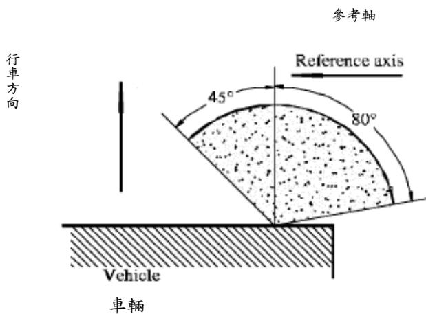
圖一 電動自行車成對前位置燈水平照射角度
