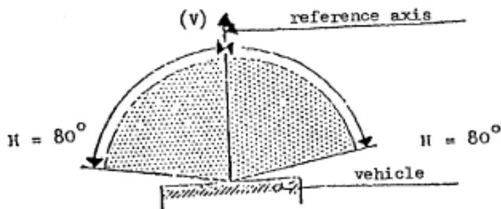
圖三 電動自行車單燈式前位置燈水平照射角度
