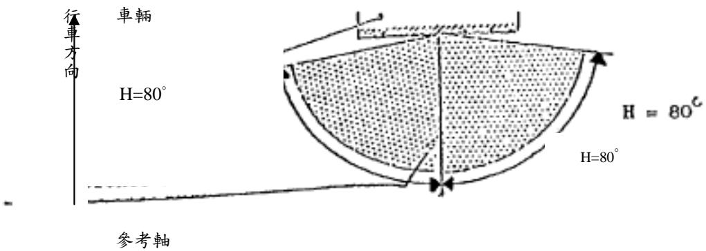
圖三 電動自行車單燈式尾燈水平照射角度
